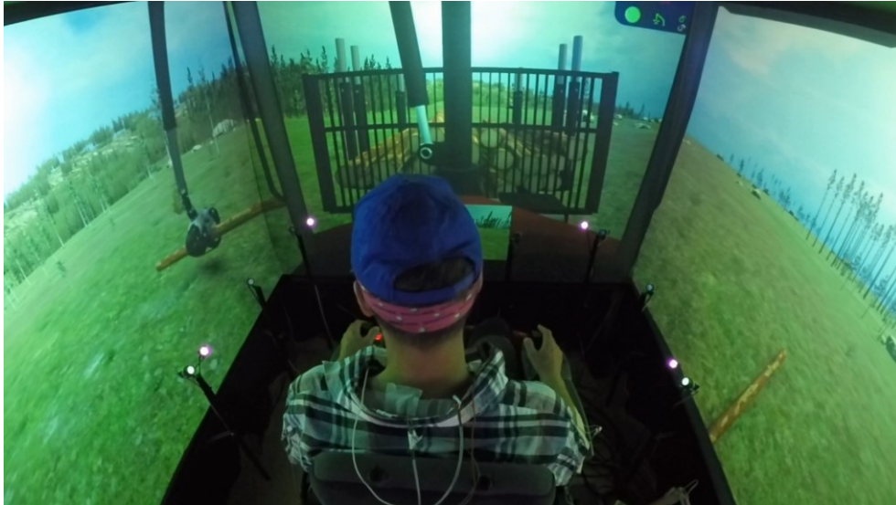
Figur 2. Från utförandet av uppgiften. EMG-elektroder har placerats på skuldran och underarmarna samt en NIRS-sensor i pannan.
